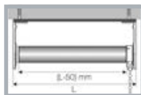
VISTA FRONTALE - Per il comando demoltiplicato. Ingombro telo: sottrarre 50 mm dalla larghezza.
